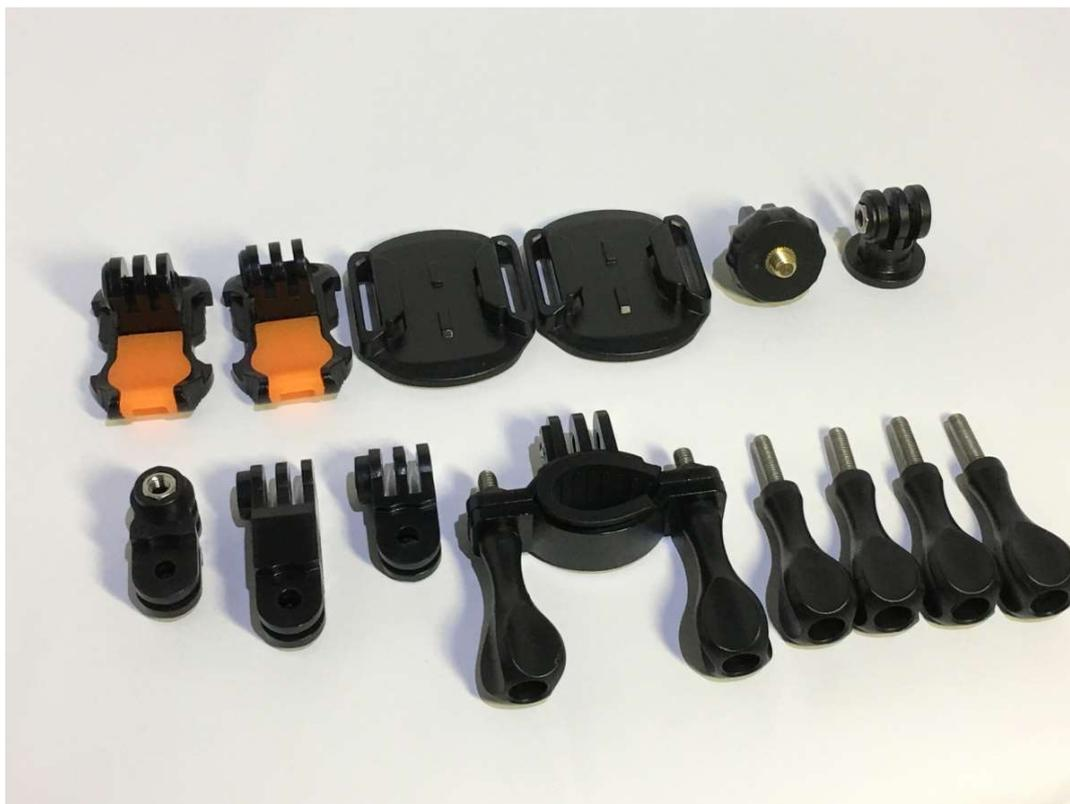
主副機與支架的結合，讓消費者能夠簡易的拆裝，一個底座與一個支架再加上一根螺桿，就可以安裝好。支架的橘色橡膠軟墊為安全扣設計，因車輛有不同頻率的震動會有共振發生，進而可能將母座與支架之間震離，該設計同時也減緩不必要的震動傳至主、副機，降低共振因素導致數據辦干擾。螺桿與螺母的金屬材質都為鋼材，避免因潮濕所產生的鏽蝕。
